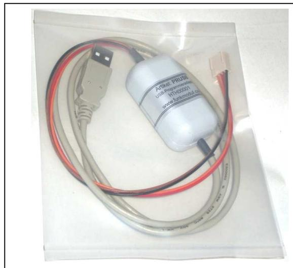
Dieser USB-Programmieradapter kann für die meisten programmierbaren Komponenten als Ersatz für den seriellen Schnittstellenwandler PRAD02 verwendet werden, wenn keine serielle Schnittstelle zur Verfügung steht. Dabei wird in der Regel kein weiteres Adapterkabel zu den Funkeinheiten benötigt, da deren 4-pol. Standardschnittstelle direkt damit adaptiert werden kann.
