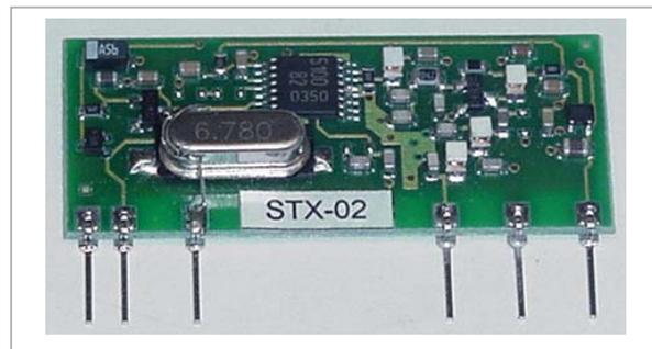
Dieses Hybridmodul moduliert ein digitales Signal (max. 10kHz-Rechteck) auf die ISM-Frequenz 433,92MHz. Die HF-Leistung wird über eine externe Antenne abgestrahlt (z.B. Lambda/4).
