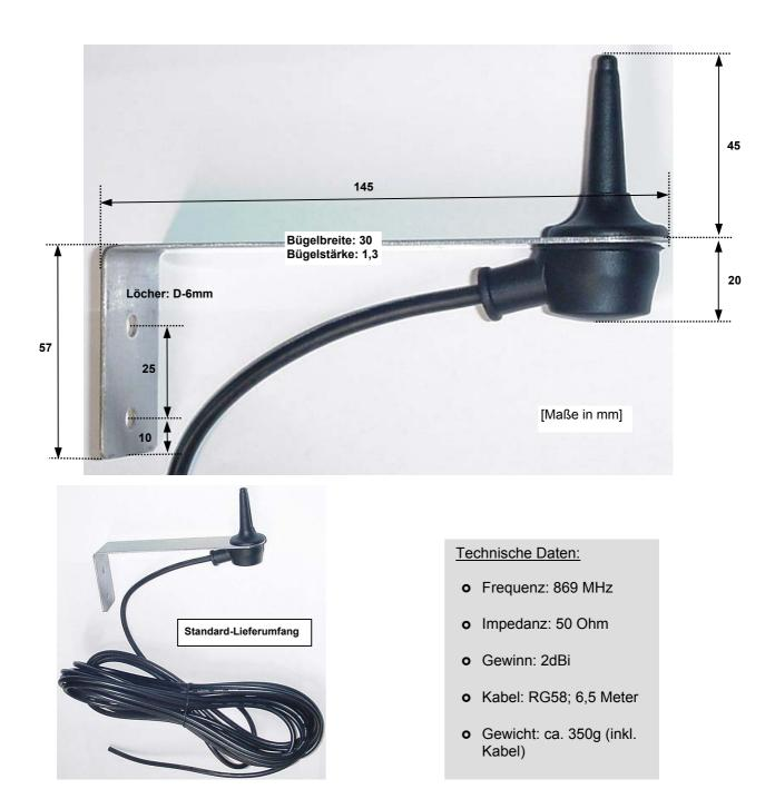
Diese Antenne ist durch ihre Konstruktion für den Außeneinsatz geeignet. Sie wird fertig vormontiert auf einem Edelstahl-Anschlussbügel (gratfrei!) geliefert. Der Antennenstab ist abschraubbar. Das RG58-Kabel ist 6,5m lang und kann vom Anwender auf die benötigte Länge gekürzt werden.
